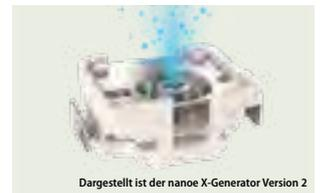
4 | Kein Filterwechsel, keine Servicearbeiten. Zur Erzeugung der nanoe™ X-Partikel (mit Hydroxylradikalen gefüllte Wassertröpfchen) wird die natürliche Luftfeuchte genutzt, die an der aus Titan gefertigten Zerstäubungselektrode kondensiert. Das nanoe™ X-System arbeitet also vollkommen wartungsfrei.
