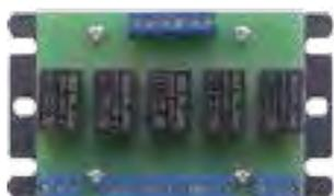
Die Zusatzplatine PFEA-Modus DC bietet für die Panasonic PACi und VRF-Inneneinheiten die Möglichkeit einer Statusmeldung der Betriebsarten. Die Zusatzplatine wird an den OPTION Stecksocket auf der Steuerungsplatine der Inneneinheit angeschlossen.
