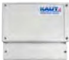
Grundlastumschaltung für 2 oder 3 Systeme mit Störungsüberwachung inkl. einstellbarer Umschaltvorgabe (1/7/14/30Tage) für gleichmäßigen Betrieb der Systeme. Für die Mono-Split und VRF Baureihen in Kombination mit Zusatzplatten. Externe Kontakte: Betriebs-, Alarm- und Sammelstörung mit Wechselkontakt. Optionaler Anschluss für Raumtemperaturüberwachung.
