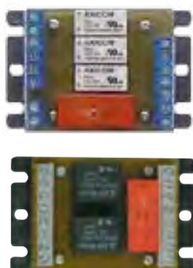
Die Zusatzplatine PFEA-CHECK-IN 2 bietet für die Panasonic PACi und VRF-Inneneinheiten die Möglichkeit zur Einbindung in Hotel Check-In Systeme wie z.B. Kartenleser, Schlüsselschalter oder Bewegungsmelder. Zusätzlich sind Betriebs- und Störmeldungskontakte vorhanden. Die Zusatzplatine ist in weiteren Versionen verfügbar:
